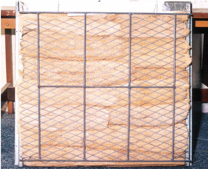
شكل (٢). وضع مادة اللوف الطبيعي على شبك المكيف الصحراوي.
